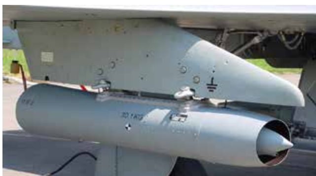
Figur 2: Höhenluftfilter-Aggregate: Detail-Aufnahme eines Sammelgerätes.
