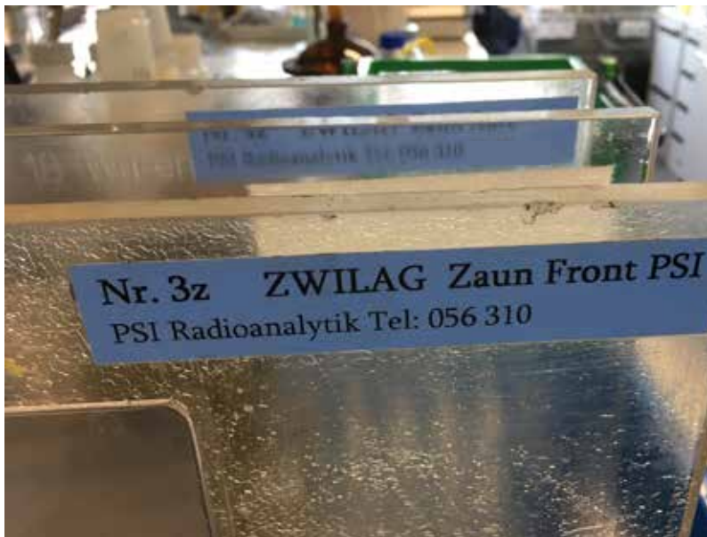
Figur 1 : Staubfangplatten, welche im Labor mit frischer Vaseline-Beschichtung vorbereitet sind, bereit zur Montage an den Sammelstationen (Bild: P. Kramer).
