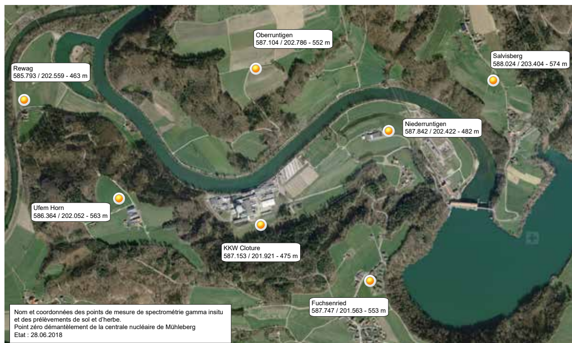
Figure 2: Emplacement des 7 sites de mesure de spectrométrie gamma in situ et de prélèvement de sol et de végétation dans la région de la centrale nucléaire de Mühleberg en 2019.
