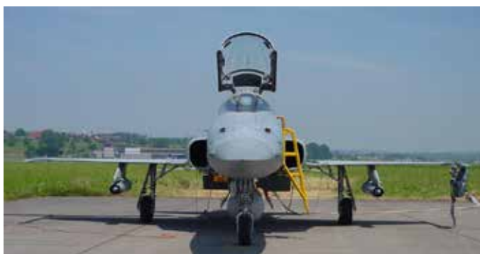
Figur 1 : Höhenluftfilter-Aggregate montiert an den beiden Flügeln eines Tiger.
