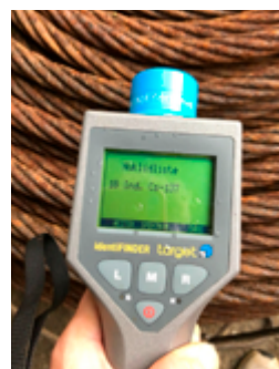
Abb. 12 Detektion der Caesium-137 Quelle im Seilbahnseil
