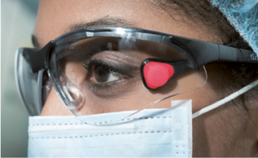
Abb. 16 Augenlinsendosimeter messen die Strahlenbelastung am genauesten, sofern sie unter der Schutzbrille bei dem Auge getragen werden, das stärker exponiert ist. [Bildquelle: IRSN_Fiche_dosimetre_Cristallin.pdf]
