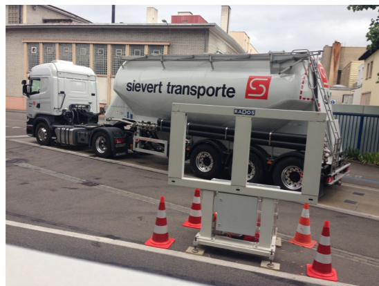
Abb.16 Messung der Radioaktivität bei der Anlieferung von Abfällen in einer KVA
