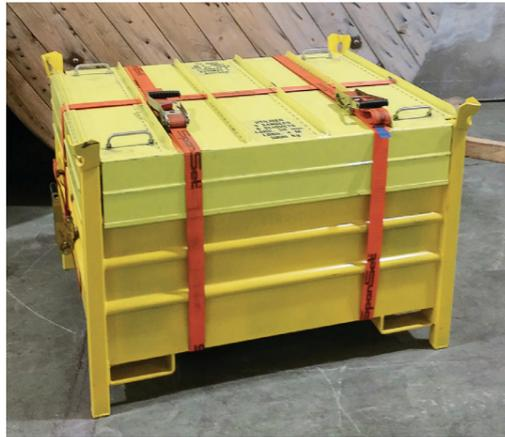
Abb. 5: Beispiel für einen Transportbehälter für loses Material (Quelle CERN)
