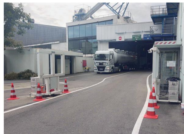
Abb. 8: Messportal bei der Zufahrt der Abfall-Abloadestelle in der Kehrichtverwertungsanlage in Basel
