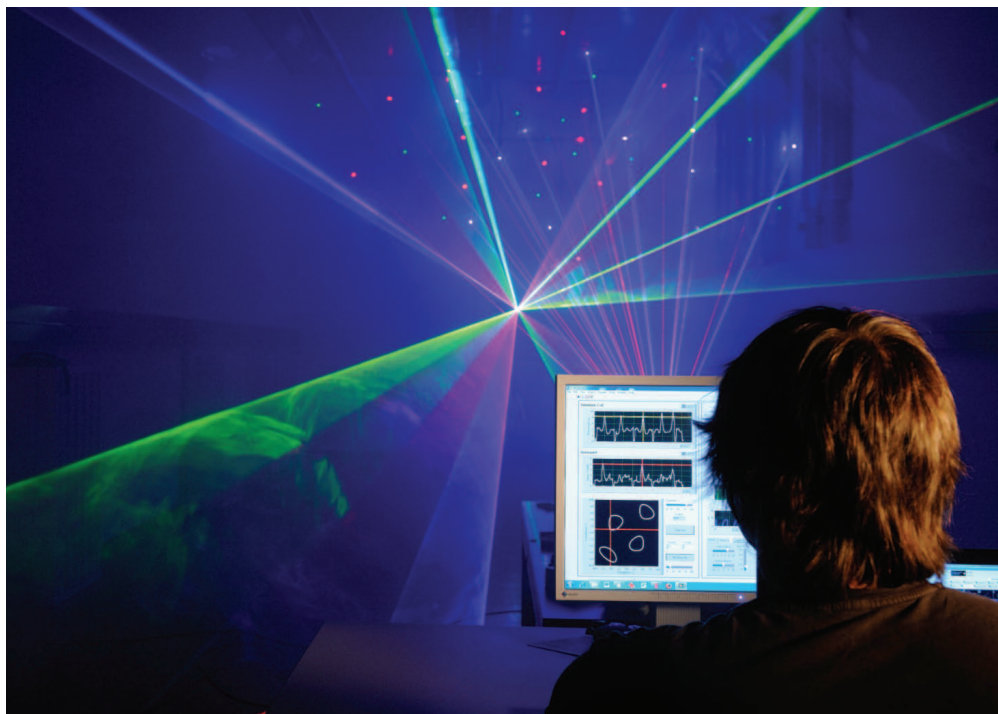
Abb. 19: Der Laser Show Risk Analyzer (LASRA) misst geplante Lasershows (Quelle: Metas)
