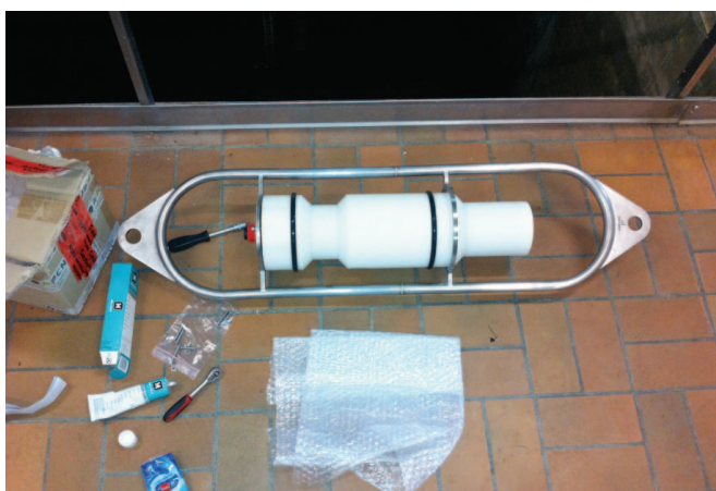
Figure 10: Installation d'une sonde de mesure aquatique
