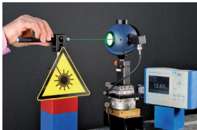
Abb. 18: Messung eines Laserpointers im Labor Optik des METAS.
