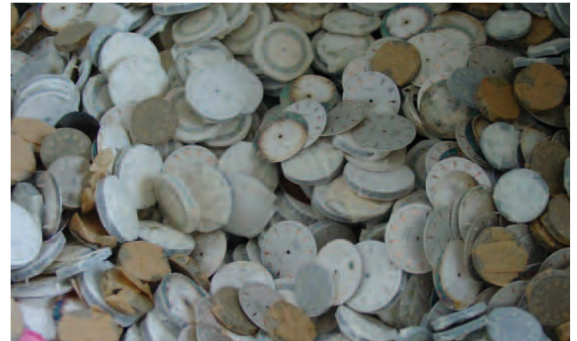
Figur 1: Aussortierte Uhrenzifferblätter, die Leuchtfarbe mit radioaktivem Ra-226 und Tritium enthalten
