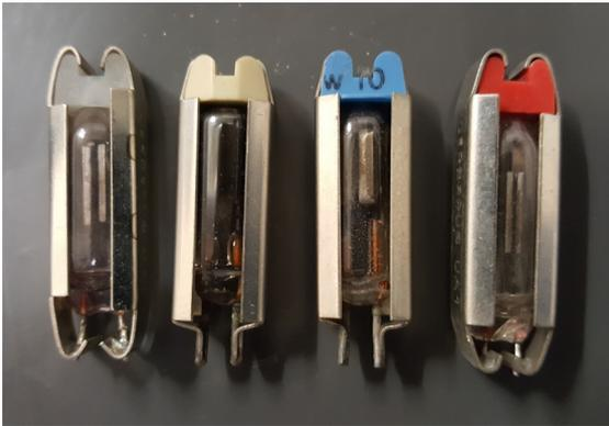
Abb. 11: Übersicht der Überspannungsableiter mit Ra-226 der Firma Cerberus
