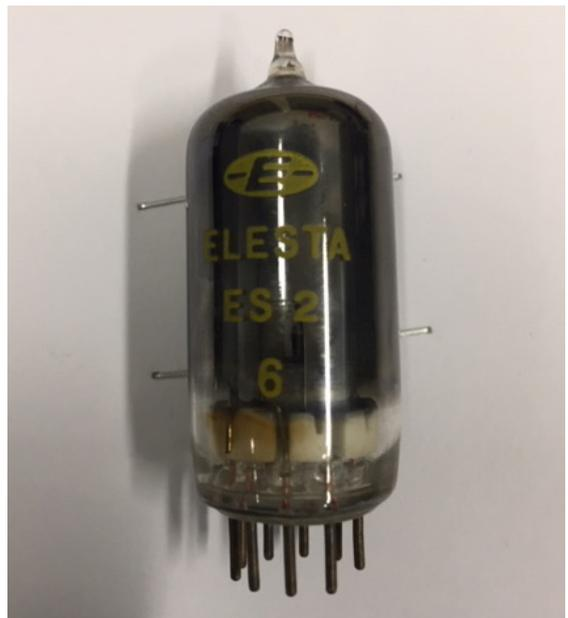
Abb. 14: Elektronenröhre mit Ra-226, Modell ES2 der Firma Elesta
