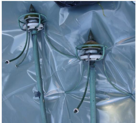
Abb. 10: Blitzableiter mit Ra-226 demontiert, Nahaufnahme
