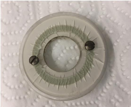
Abb. 7: Schalterbeleuchtung mit Ra-226 Leuchtfarbe
