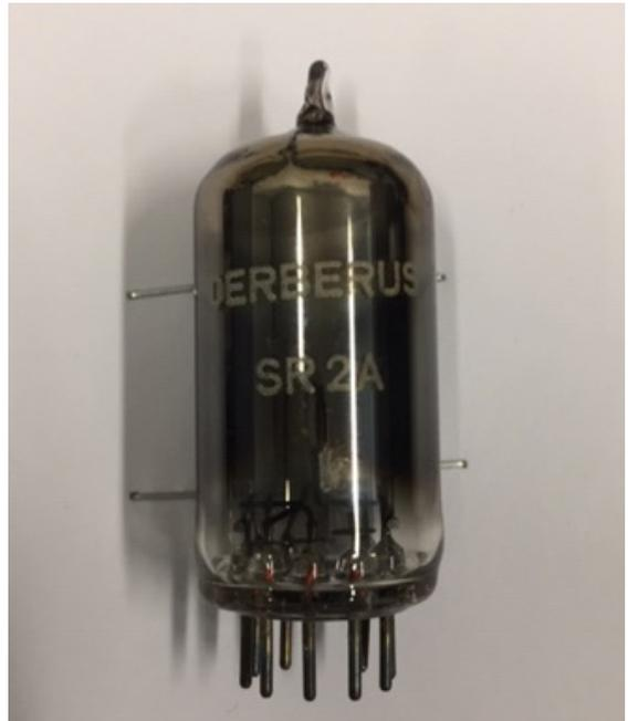
Abb. 13: Elektronenröhre mit Ra-226, Modell SR2A der Firma Cerberus
