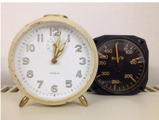
Abb. 16: Wecker und Fluginstrument mit Radium
