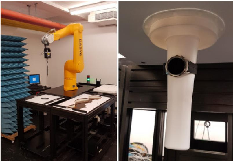
**Abbildung 2 Dosimetrisches Masssystem Phantom eines Armes mit Smartwatch**
