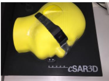
Abbildung 1 Flaches Phantom eines Kopfes mit Smartwatch
