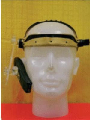
Abbildung 2: Kopfphantom für die Bestimmung des SAR-Wertes. Bildquelle [13]
