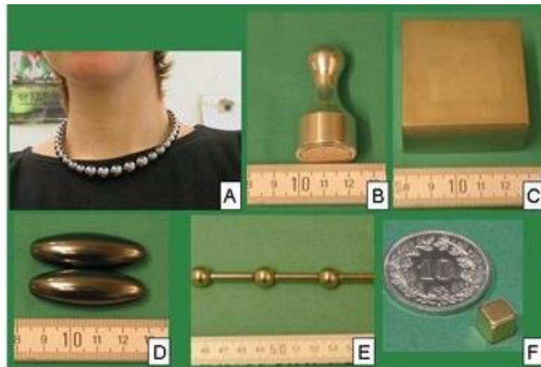
Figur 1: Eine Auswahl von Neodymmagneten: A: Halskette (Magnetkugeln von 8, 10 und 13 mm Durchmesser), B: Büromagnet, C: Quader gross, D: Spielzeugmagnet, E: Stäbchen und Stahlkugeln (nicht magnetisch), F: Würfelchen
